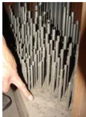
Obr. 1 Silné znečistenie organu nánosmi prachu
